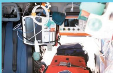
乗員の出入り口付近から見たストレッチャー格納部。機内には心電図モニター・人工呼吸器・除細動器などの機器が効率良く格納されています。
